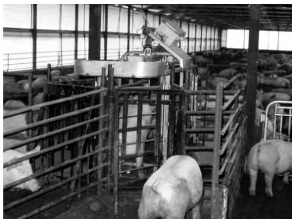
写真5 計量機を通過する時、目的の体重に達したら右(出荷スペース)、達しなかったら左(餌場)への扉が開く
