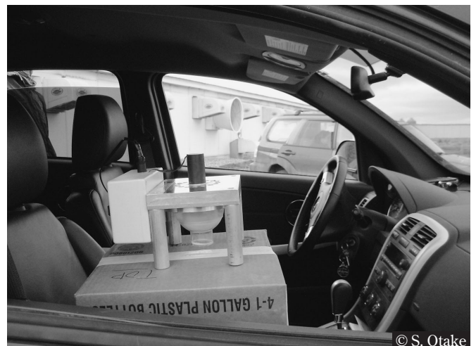
写真3 農場周辺の空気を採取してPRRSウイルスの存在をチェックする
