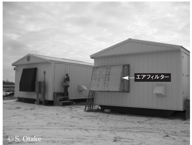
写真1 PRRS防疫対策として空気フィルターを設置した豚舎
