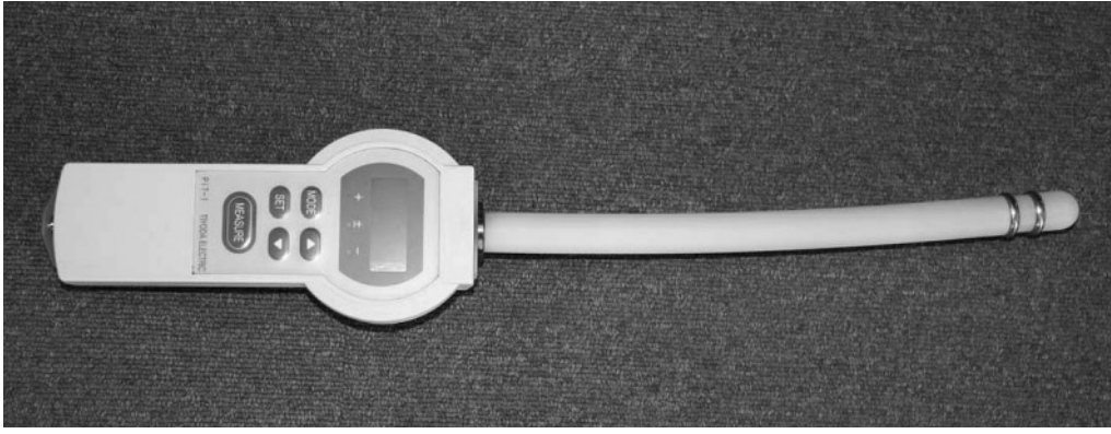
写真1 VER測定器（ブリードテスタ：千代田電機工業株）
