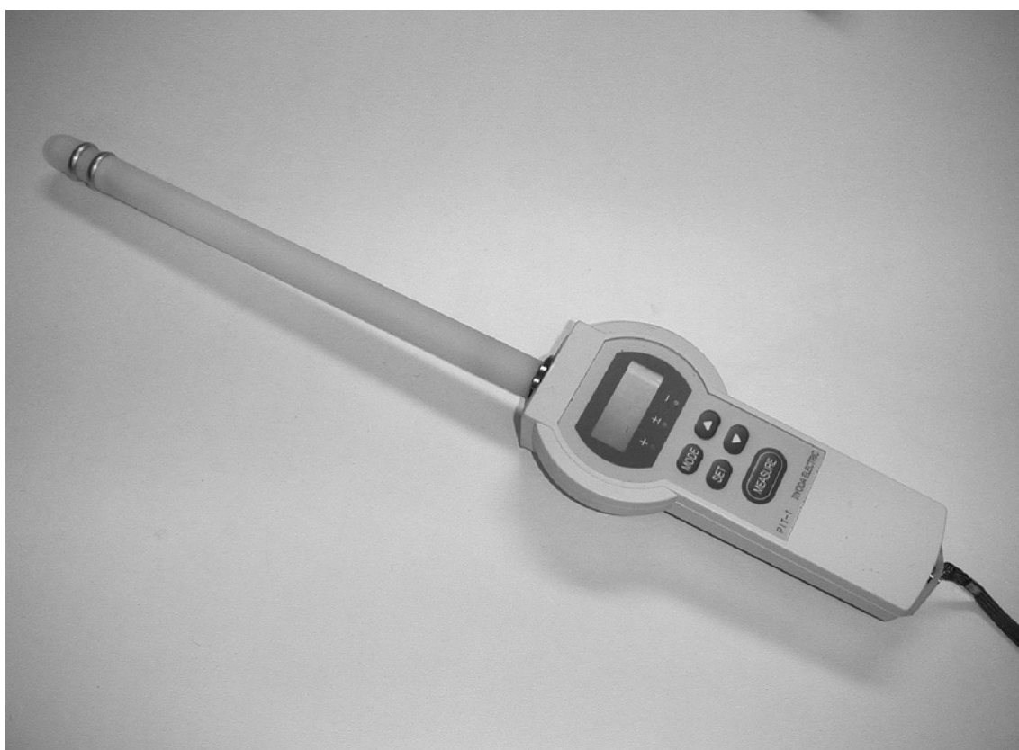
写真3 豚用膈内電気抵抗測定器 棒状の部分を膈内に挿入して電気抵抗を測定。 数値が最低となった1~2日後が発情。
